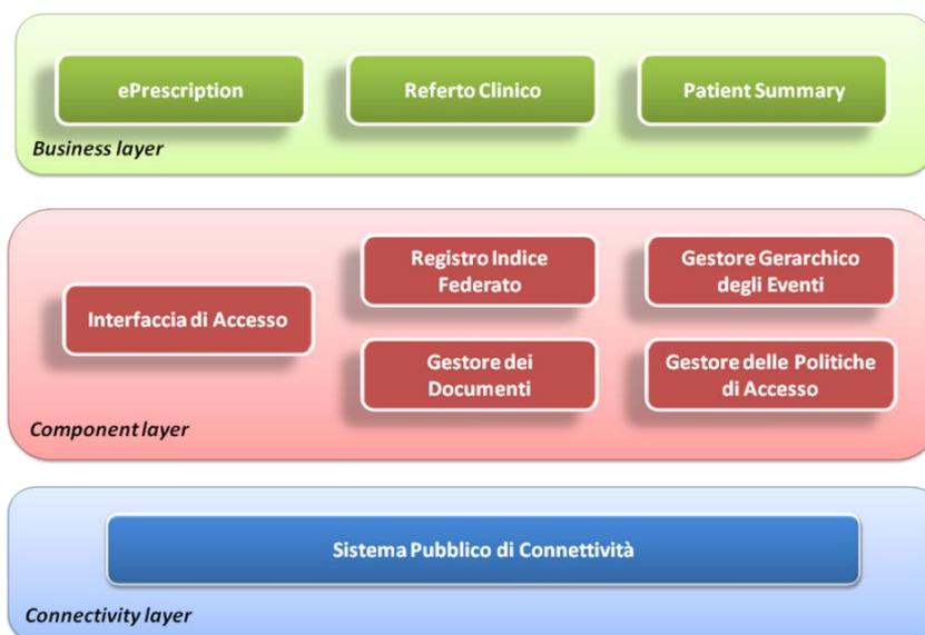
Figura 1. Architettura software dell'infrastruttura InFSE
